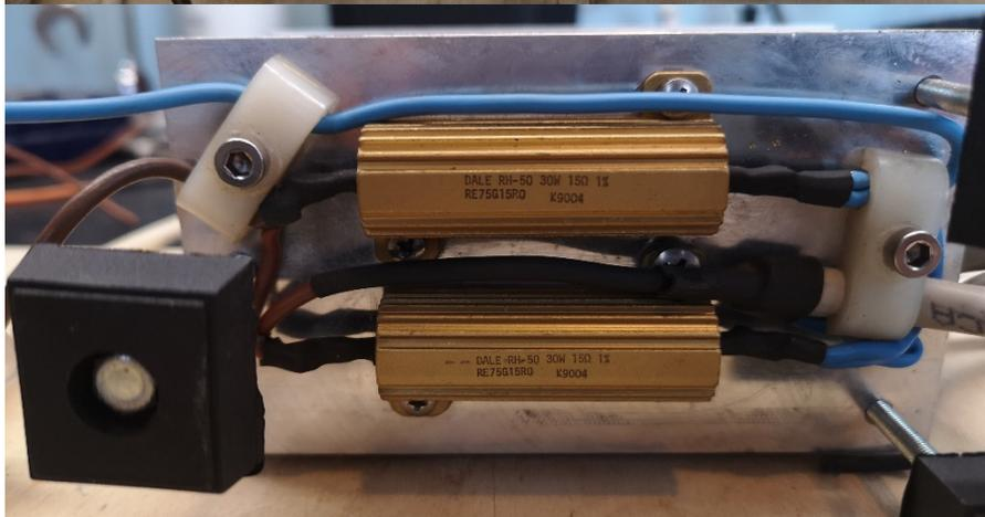
L'accrocchio fu concepito per dare un carico fittizio alle testate quando si eseguono test e misure, ma decisi di dotarlo anche di cavi volanti ( oltre che il jack ) per possibili implementazioni tipo questa.
