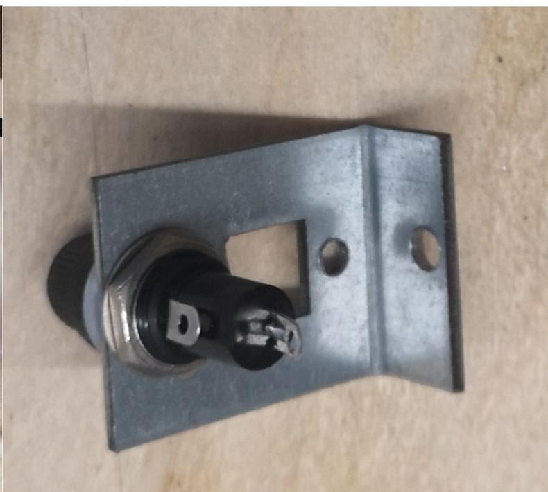
Nel mio caso : uno da 2 A a monte del T.A. e uno da 250 mA in serie ad un ramo del secondario del T.A. che porta la tensione alternata all'ingresso del primario del T.U.
