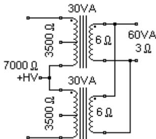
Avendo a disposizione due trasformatori per Push-Pull da 30VA 3500W/6 W, collegando gli avvolgimenti primari in parallelo e gli avvolgimenti secondari in serie si ottiene come risultato complessivo come se fosse un unico trasformatore di uscita da 60VA 1750W/12 W.
