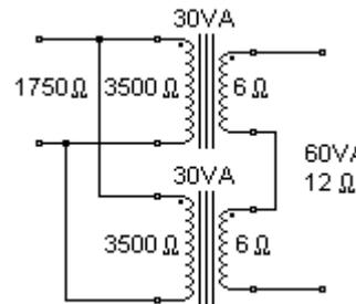
**Esempi di Trasformatori di Uscita collegati in Serie e in Parallelo per PP**
