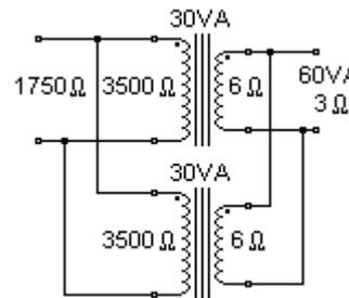
Avendo a disposizione due trasformatori per single-ended da 30VA 3500W/6 W, collegando gli avvolgimenti primari in serie e gli avvolgimenti secondari in parallelo si ottiene come risultato complessivo come se fosse un unico trasformatore di uscita da 60VA 7000W/3 W.
