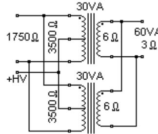
Avendo a disposizione due trasformatori per Push-Pull da 30VA 3500W/6 W, collegando gli avvolgimenti primari in serie e gli avvolgimenti secondari in parallelo si ottiene come risultato complessivo come se fosse un unico trasformatore di uscita da 60VA 7000W/3 W.
