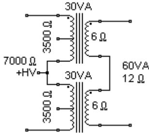
Avendo a disposizione due trasformatori per Push-Pull da 30VA 3500W/6 W, collegando gli avvolgimenti primari in parallelo e gli avvolgimenti secondari in parallelo si ottiene come risultato complessivo come se fosse un unico trasformatore di uscita da 60VA 1750W/3 W.
