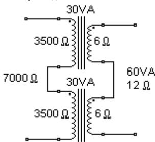
Avendo a disposizione due trasformatori per single-ended da 30VA 3500W/6 W, collegando gli avvolgimenti primari in parallelo e gli avvolgimenti secondari in parallelo si ottiene come risultato complessivo come se fosse un unico trasformatore di uscita da 60VA 1750W/3 W.
