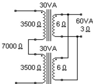
Avendo a disposizione due trasformatori per single-ended da 30VA 3500W/6 W, collegando gli avvolgimenti primari in parallelo e gli avvolgimenti secondari in serie si ottiene come risultato complessivo come se fosse un unico trasformatore di uscita da 60VA 1750W/12 W.
